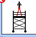
Zvyšování místa práce na lešení dalšími předměty (např. žebříky, bedny s nářadím, materiál), vylézat na zábradlí.
