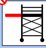
Připojování dalších pracovních podlah či další objekty na vnější stranu lešení, není-li to dovoleno návodem výrobce.
