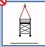
Zvedání nebo zavěšování lešení např. za pomocí vysokozvižného vozíku nebo jeřábu.
