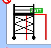
Odstavovat lešení na místech, která narušují bezpečnost pracoviště, např. před únikovými východy, před schodišti, v únikových komunikacích, před hlavními vypínači a uzávěry.
