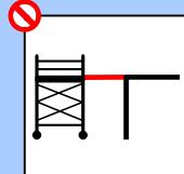
Zřizování můstků / přechodových lávek mezi lešením a budovou / jinou konstrukcí.
