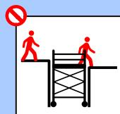
Používání lešení k získání přístupu / pro výstup k jiným konstrukcím a částem budov.
