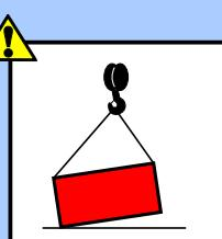
Před zahájením manipulace vždy provedte zkušební zdvih.
